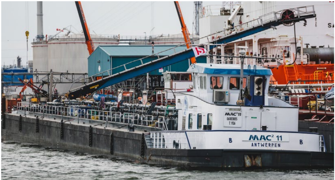
Figura 9: Gabarra dedicada a la recogida de basuras y desechos oleosos en el puerto de Amberes (Bélgica). (Fotografía: Mac², http://www.mac-2.be )
